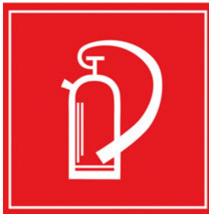
Das Brandschutzzeichen F005 markiert den Standort eines Feuerlöschers
